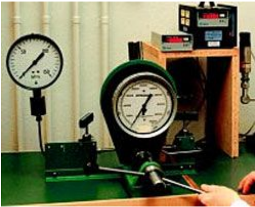
Figura 3. Calibração de um manômetro pelo método indireto ou da comparação.
